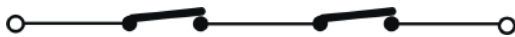
Connexion de deux contacts N.F. en série (Ex.: Photocellules, Stop, Bord, etc.)
